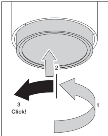
Bis zum Anschlag drehen, nach oben drücken und weiter drehen, bis das Objektiv sich entriegelt.
