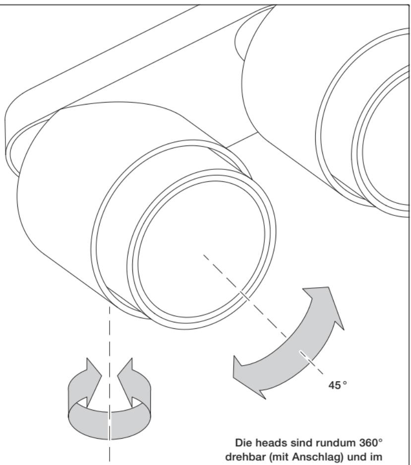
Die heads sind rundum 360° drehbar (mit Anschlag) und im Winkel bis 45° ausrichtbar.
