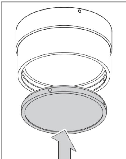
Insert in das Objektiv einsetzen
