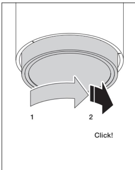
Anschließend im Uhrzeigersinn drehen bis es hörbar einrastet.
